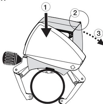
Разрезав трубу нажмите кнопку UNLOCK, так, чтобы была видна желтая метка и снимите блокировку (Рис. L/1). Теперь поднимите двигатель в вертикальное положение (Рис. L/2). Разблокируйте выключатель (Рис. L/3). Когда нож находится в неподвижном состоянии, снимите труборез с трубы, освободив ручку (Рис. L/4). Убедитесь в том, что подвижное нижнее ограждение диска опущено в безопасное положение.
