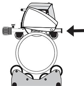
Rychlost posuvu volte s ohledem na materiál potrubí a tloušťku jeho stěny. Příliš vysoká rychlost řezu může poškodit kotouč, přetížit pilu a přinášet slabé pracovní výsledky. Zejména při použití kotouče Cut Bevel by měla být rychlost posuvu kotouče dostatečně pomalá, aby byla zaručena kvalita zkosení.
