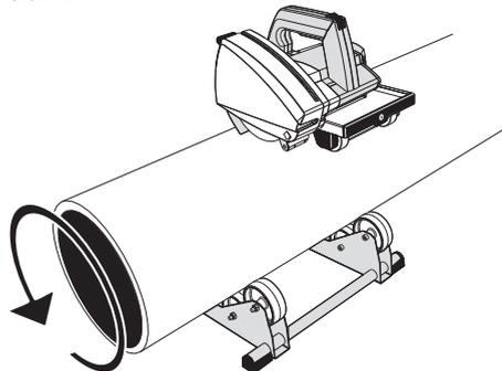
Jakmile bude potrubí odříznuto, zatlačte odjišťovací tlačítko (UNLOCK) směrem dopředu tak, aby se objevila žlutá značka a aby došlo k odblokování (obr. L). Nyní zvedněte jednotku motoru do počáteční polohy. Uvolníte spouštěcí spínač. Po zdvižení pily z potrubí se ujistěte, zda je pohyblivý kryt kotouče nastaven v bezpečnostní poloze (obr. M).
