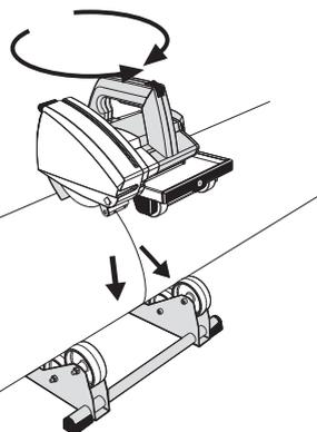
Pila Exact P400 může být také použita pro vytváření zkosení na koncích plastového potrubí. Nejdříve umístěte pilu na horní část potrubí tak, aby se řezný kotouč kotouče Cut Bevel nacházel na konci potrubí. (obr. N) Nyní můžete zahájit práci s potrubím podle výše uvedeného postupu.
