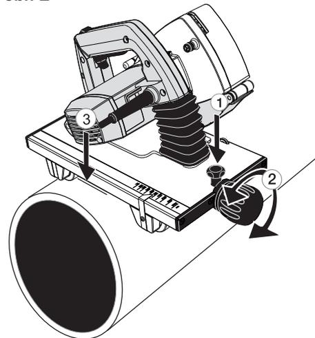
Nejdůležitější je, aby se základna ovládacího zařízení nedotýkala potrubí, ale aby pár koleček spíše podíral pilu (**obr. E3**). Nakonec zajistěte nastavení pomocí bezpečnostního šroubu (**obr. E1**) tak, aby během řezání nedošlo ke změně nastavení.
