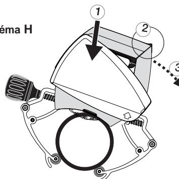
Si vous avez un problème lors du perçage ou du sciage, si vous entendez des bruits anormaux ou si des vibrations vous obligent à arrêter de scier avant d'avoir terminé, libérez la lame en appuyant sur le bouton UNLOCK jusqu'à ce que le bouton UNLOCK soit déverrouillé, et levez l'unité du moteur. Une fois le problème résolu, vous pouvez recommencer à scier.
