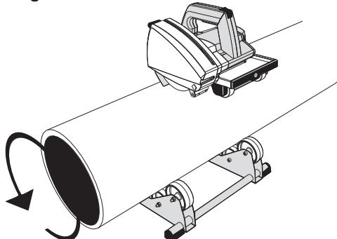
Cuando haya cortado el tubo al completo, pulse el botón de DESBLOQUEO hacia delante, hasta que la marca amarilla esté visible y se suelte el bloqueo (**Fig. L**). Ahora, levante la unidad del motor hasta la posición de inicio. Suelte el interruptor de alimentación. Una vez que se levante la sierra del tubo, compruebe que el protector del movimiento de cuchilla se haya colocado en posición de seguridad (**Fig. M**).
