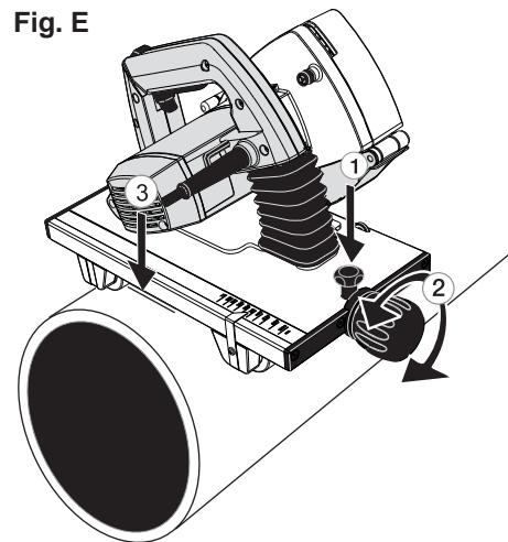
Es más importante que la base del dispositivo de dirección no toque el tubo, sino en su lugar, que los pares de ruedas soporten la sierra (**Fig. E3**). Por último, bloquee el ajuste con la tuerca de seguridad (**Fig. E1**), de forma que los ajustes no varíen durante el corte.
