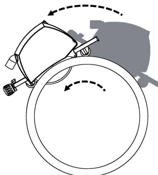
Evite que la tubería vuelva a girar y comience un nuevo movimiento de avance. Avance continuamente hacia adelante durante aproximadamente 1/6 de la circunferencia de la tubería (Fig. H).
